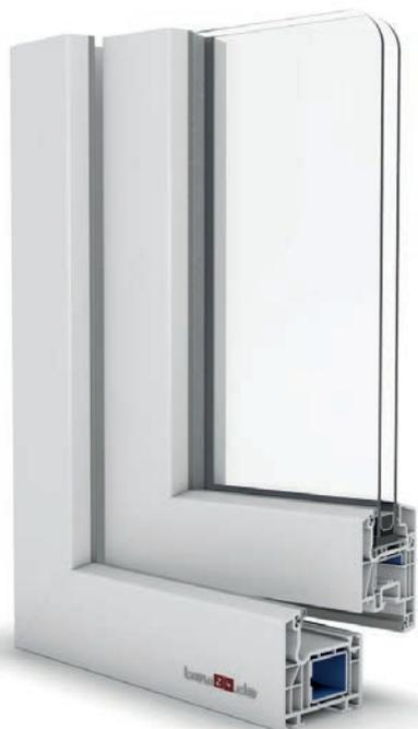
Das **Fenstersystem Corona CT 70** ist der Allrounder unter den Kunststoff-Fenstersystemen mit hoher Wärmedämmung und vielseitigem Zubehör. Die Mehrkammer- Profilkonstruktion mit fünf Kammern bildet die Grundlage für hervorragende Isolation. In Verbindung mit den umlaufenden Anschlagdichtungen und der Wärmeschutzverglasung ergeben sich Dämmwerte, wie sie noch vor einigen Jahren kaum vorstellbar waren.
