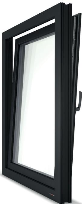
Das Kunststofffenster mit dem innovativen 7-Kammer-System **Schüco Living** ist ein Fenster, welches sich als Ziel gesetzt hat, alle Kriterien in punkto Dichtigkeit, Energieeinsparung, Funktionalität und Design zu erfüllen. Diese Kunststoff-Profilkonstruktion beruht auf zwei Dichtungsvarianten und ist mit Anschlagdichtung und zwei Dichtungsebenen oder mit zusätzlicher Mitteldichtung und drei Dichtungsebenen lieferbar.
